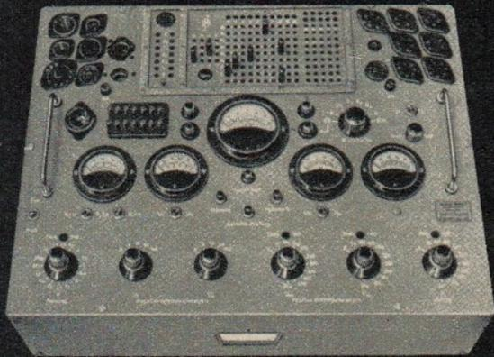
Röhrenprüf-, Meß- und Regeneriergerät
